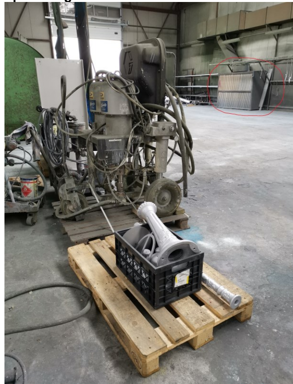
Figuur 14 luchtloze verfspuit en wandafzuiging op achtergrond
